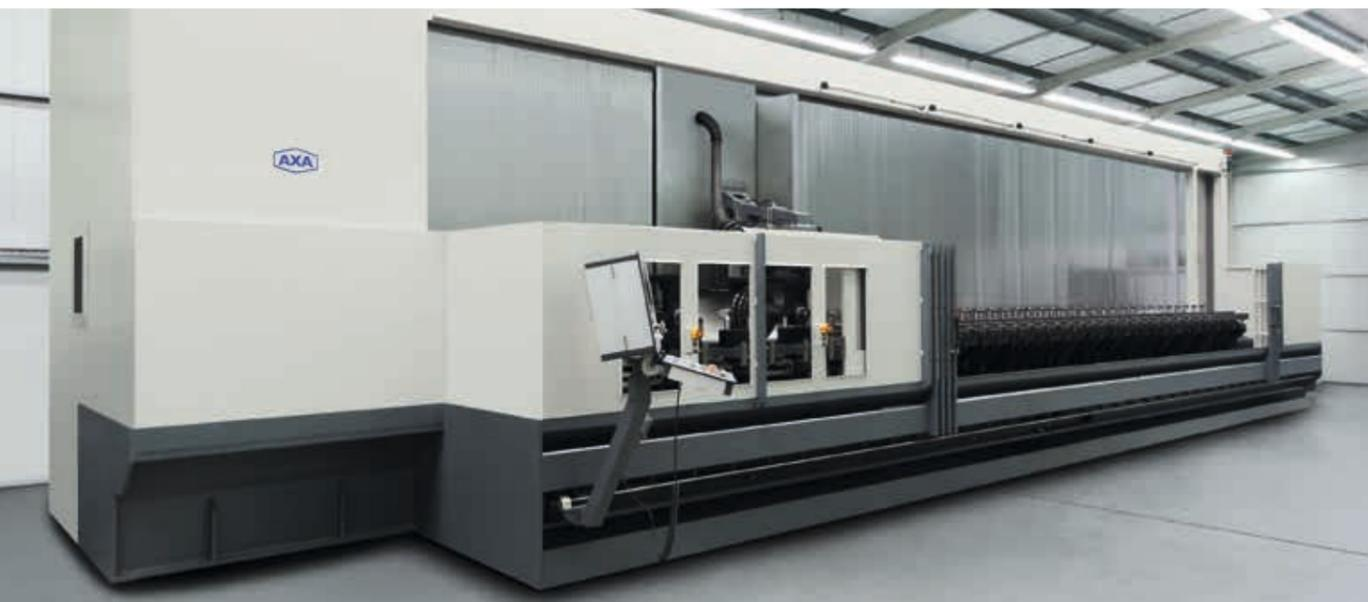
Für die schwere Zerspaltung von Schienen- und Leistenprofilen wird eine drehmomentstarke horizontale Spindel mit 3200 Nm und SK 60-Werkzeugaufnahme eingesetzt
