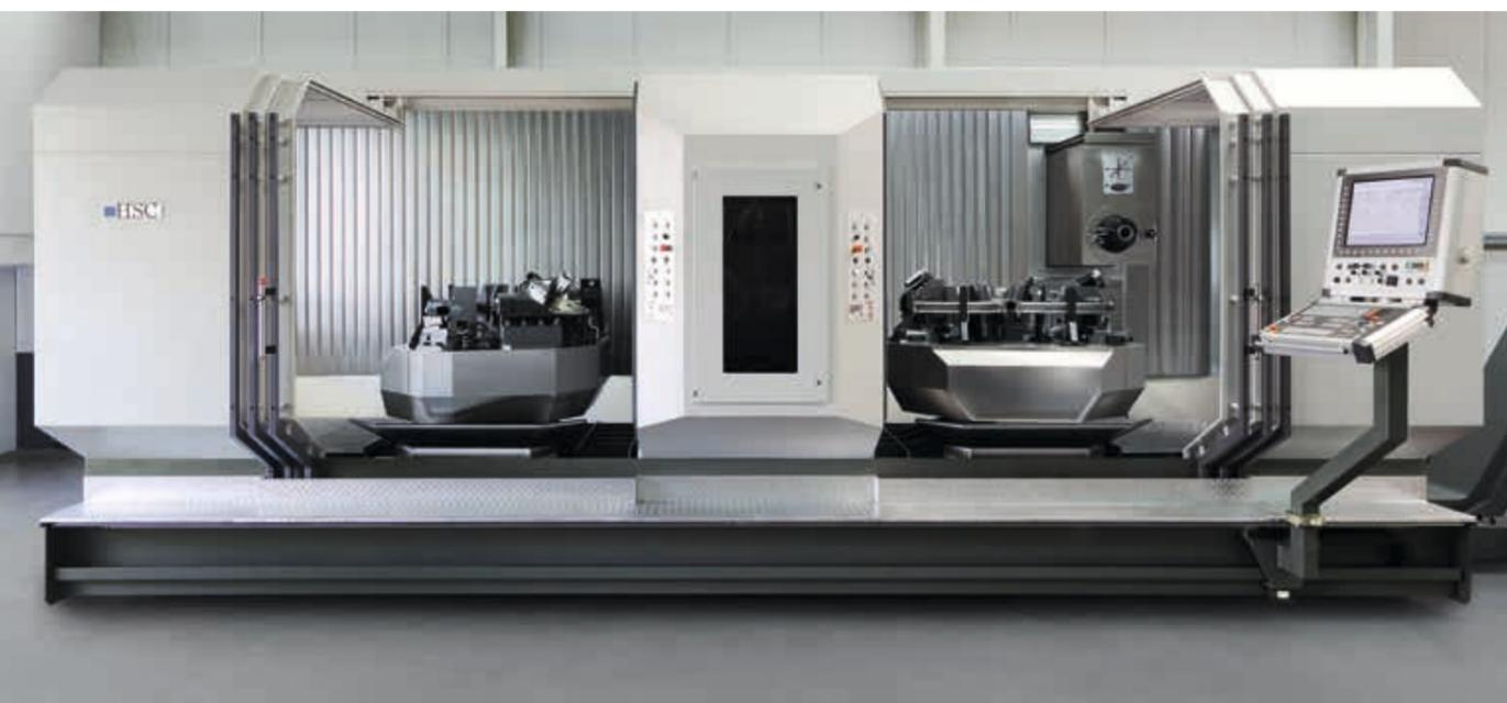
Zwei Arbeitsräume mit jeweils einem Rundtisch, getrennt durch einen mittig angeordneten Werkzeugwechsler, ermöglichen die hauptzeitparallele Aufspannung und Zerspanung an einer Maschine
