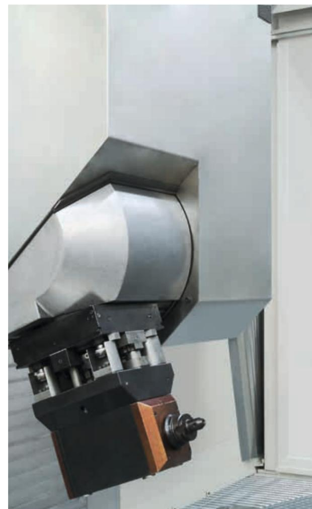
Teilweise Bearbeitung von unten durch die Verriegelung von schweren Winkelfräsköpfen über eine Vierpunktstützung
