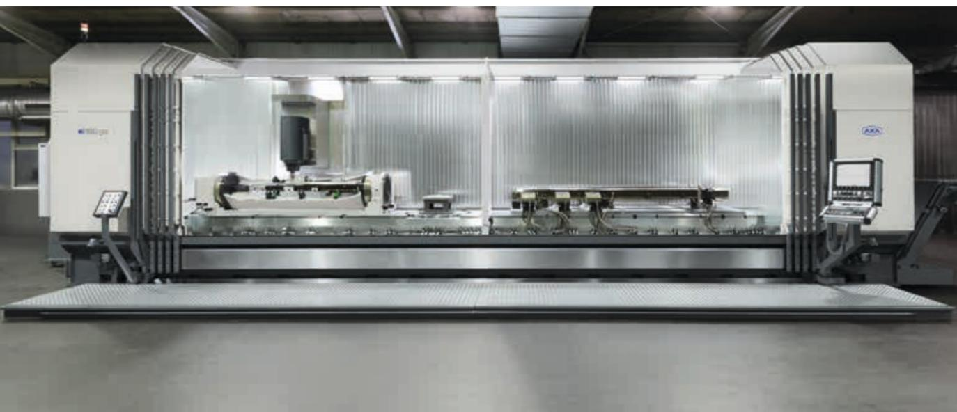
Das schwere SK 50-Pendel-Bearbeitungszentrum ist mit einer leistungsstarken Schwenkspindel ausgestattet – Unterschiedliche Spannvorrichtungen erlauben die parallele Bearbeitung verschiedener Werkstücke
