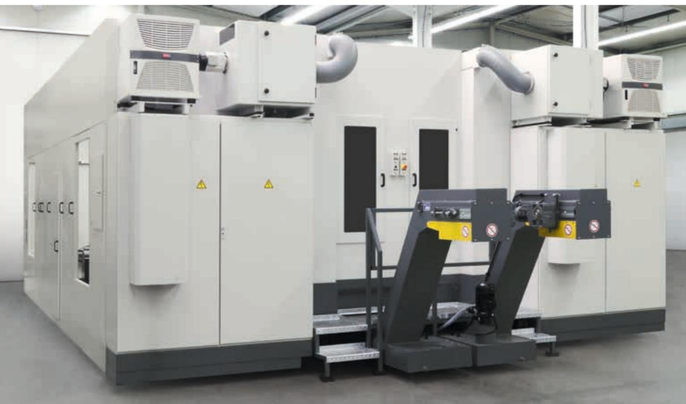
Für die Bearbeitung langer Profile werden zwei Fahrständer mit jeweils eigenem Schaltschrank und eigener Steuerung gegenüberliegend angeordnet
