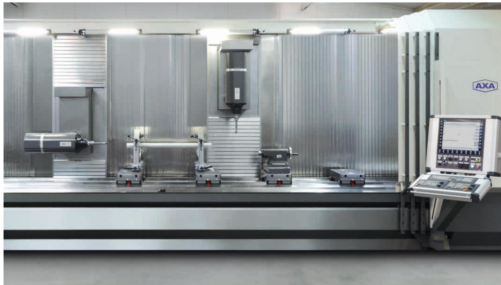
Die parallele Zerspaltung eines Werkstücks mit der Doppel-Fahrständermaschine reduziert die Fertigungszeit bis zu 50% – Bei der Stirnseiten-Bearbeitung langer Werkstücke entfallen zeitaufwendigen Langhübe
