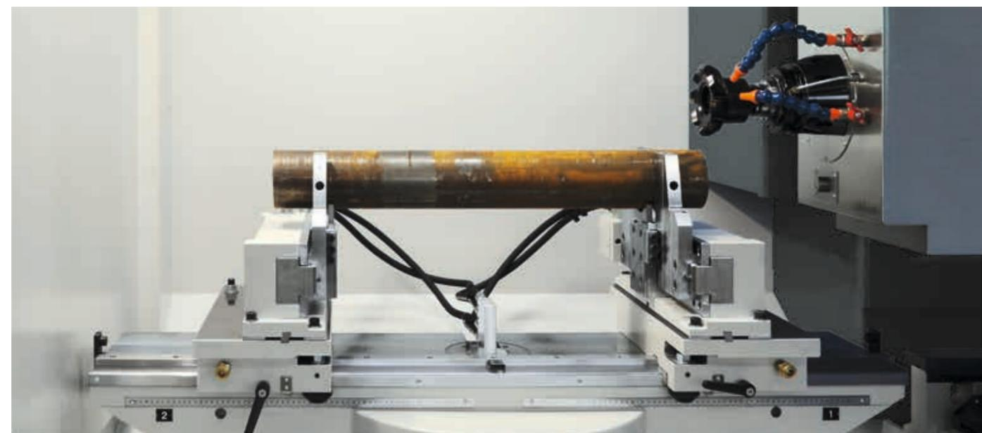
Der Abstand der manuell verschieb- und klemmbaren Zentrierspanner wird auf die Werkstücklänge angepasst
