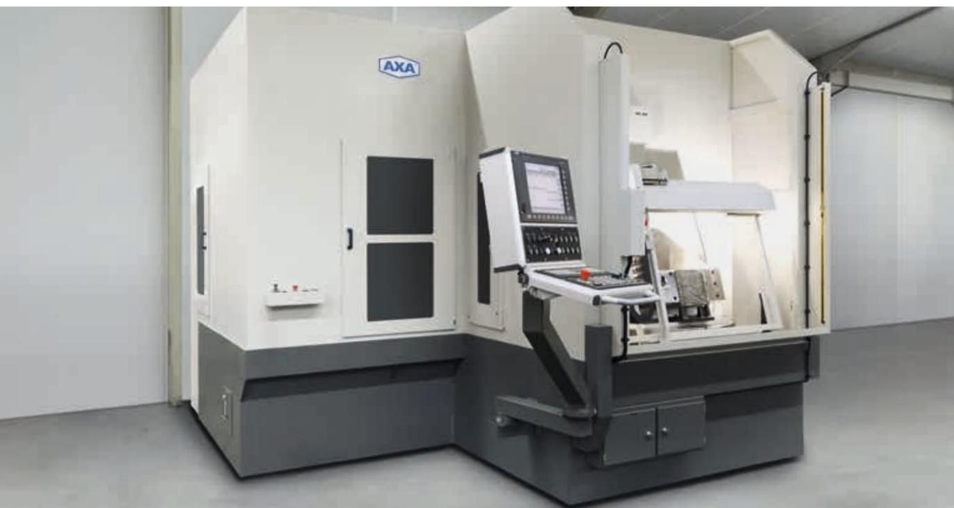
Durch die Trennung von Bestückung vorn und Arbeitsbereich hinten kann die Schwenktischmaschine hauptzeitparallel beladen werden
