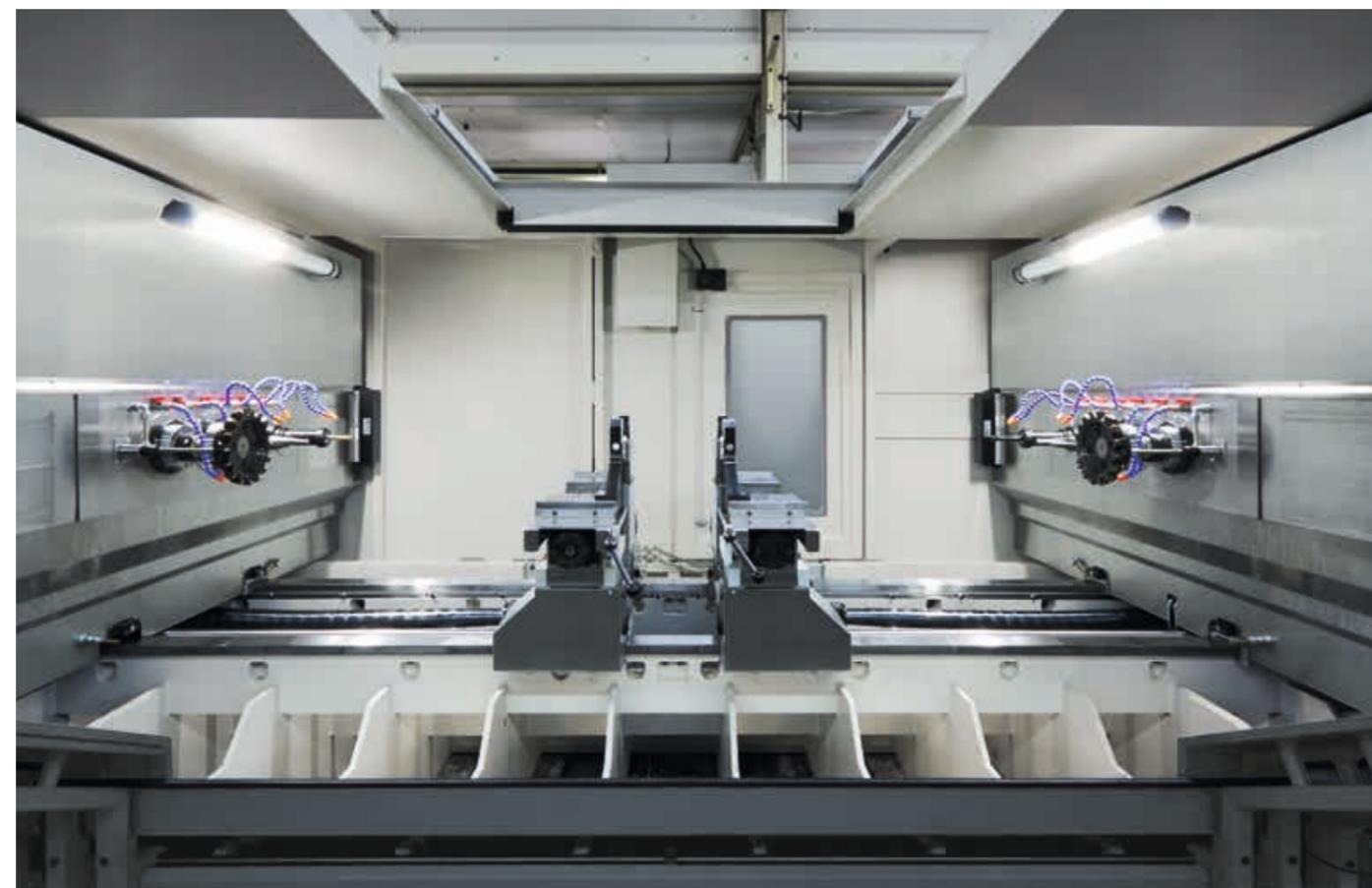
Das Doppel-Endenbearbeitungszentrum besteht aus zwei gegenüber angeordneten Z-Schlitten mit jeweils in X verfahrbaren Werkzeugsupporten
