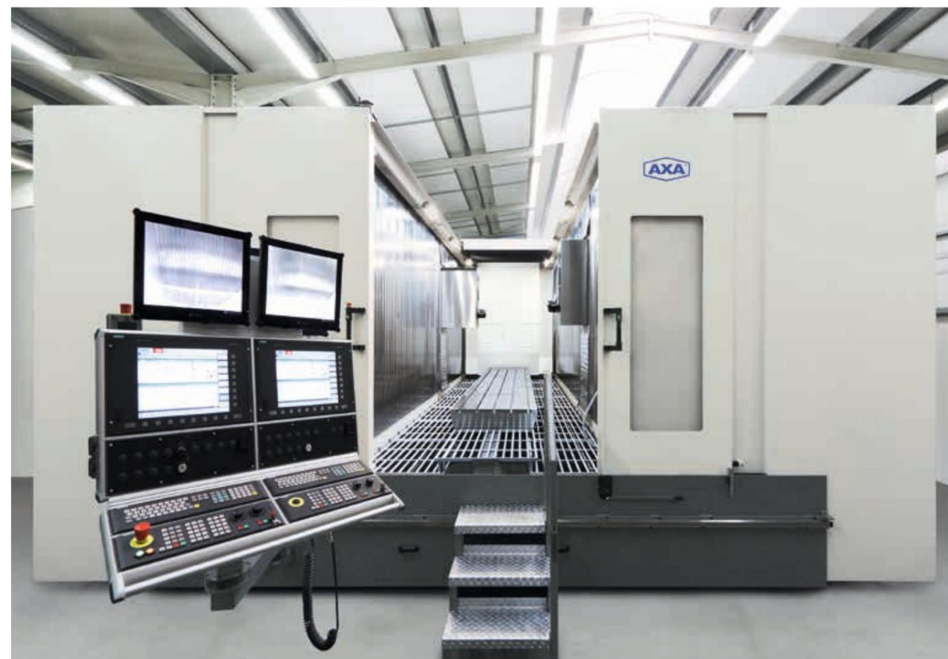
Jedem Fahrständer ist ein eigenes Bedienpult zugeordnet – Kamerasysteme erleichtern die Beobachtung der Teilefertigung
