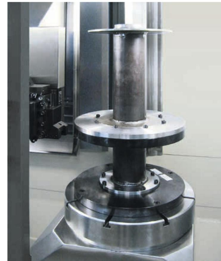
Eine durch einen Torque Motor angetriebene Rundachse wird als Drehspindel eingesetzt
