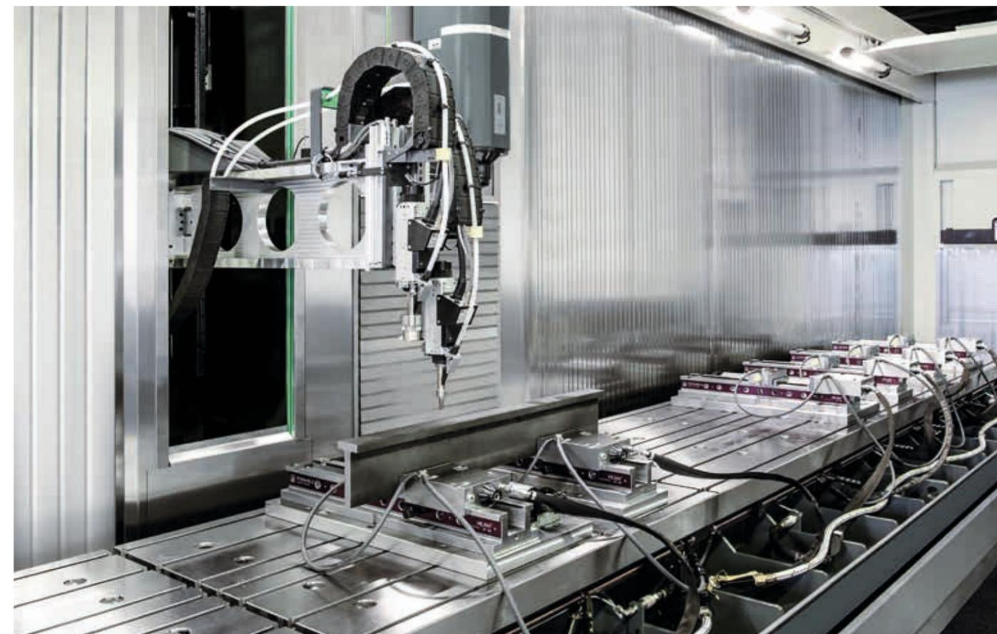
Mit dem Fahrständer verfahren zwei, in Y- und Z-Richtung unabhängige verfahrbare, Schweißköpfe – Damit werden die von einem mitfahrenden Magazin automatisch bereitgestellten Gewindebolzen angeschweißt
