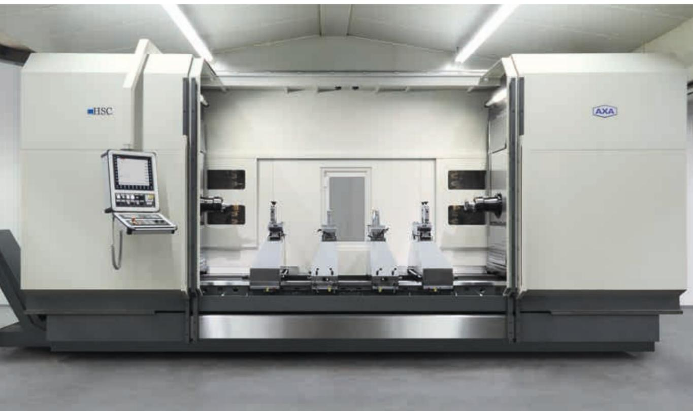
Die Enden langer Werkstücke werden auf einem horizontalen Zentrum mit zwei gegenüberliegenden in X,Y, Z-Richtung verfahrenen Arbeitsspindeln bearbeitet
