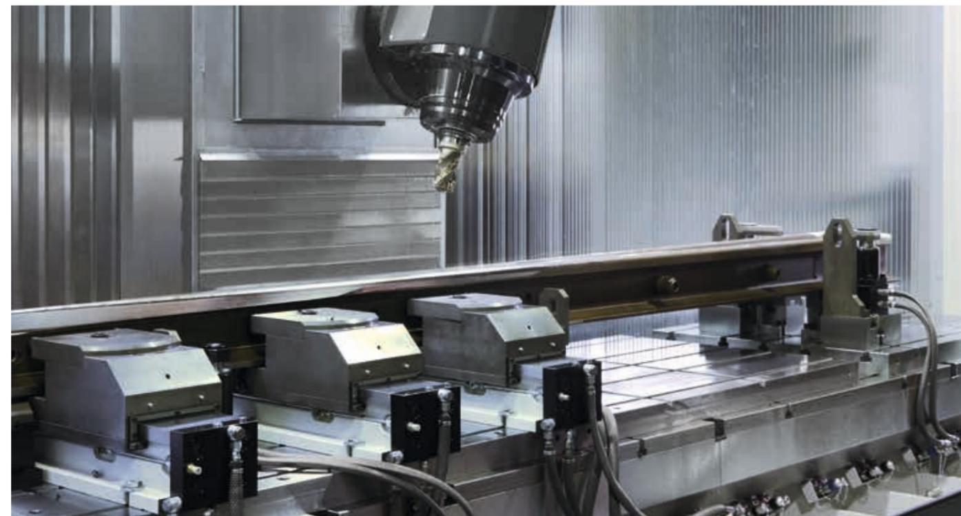
Im rechten Arbeitsraum können lange Leisten in flexibel positionierbaren Spannstöcken gefertigt werden
