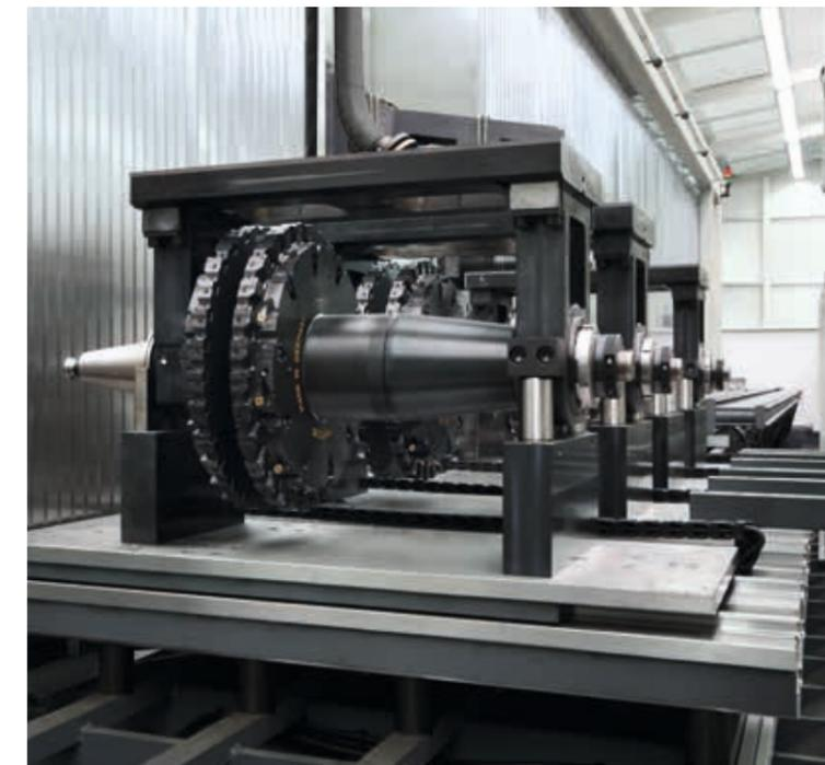
4-fach Pick up Station ermöglicht den automatischen Wechsel verschiedener Fräsdorn-Kombinationen
