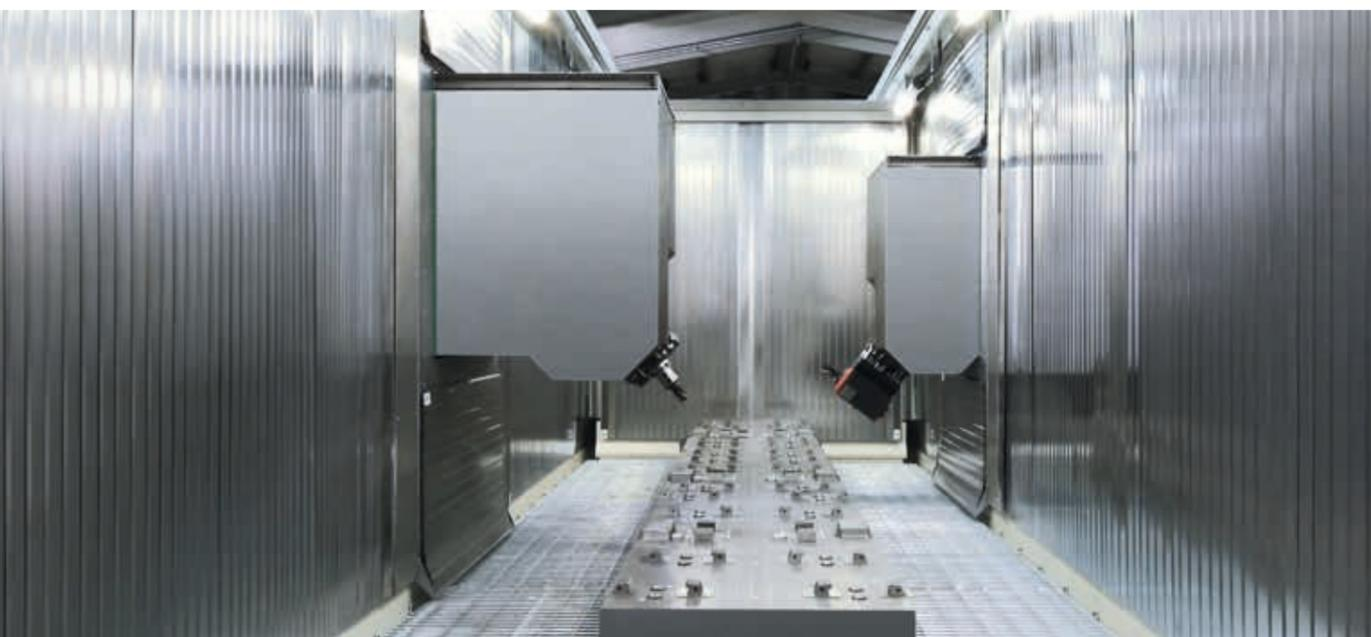
Um die X-Achse schwenkbare Arbeitsspindeln ermöglichen die flexible Fertigung beliebiger Konturen auch mit Schrägen
