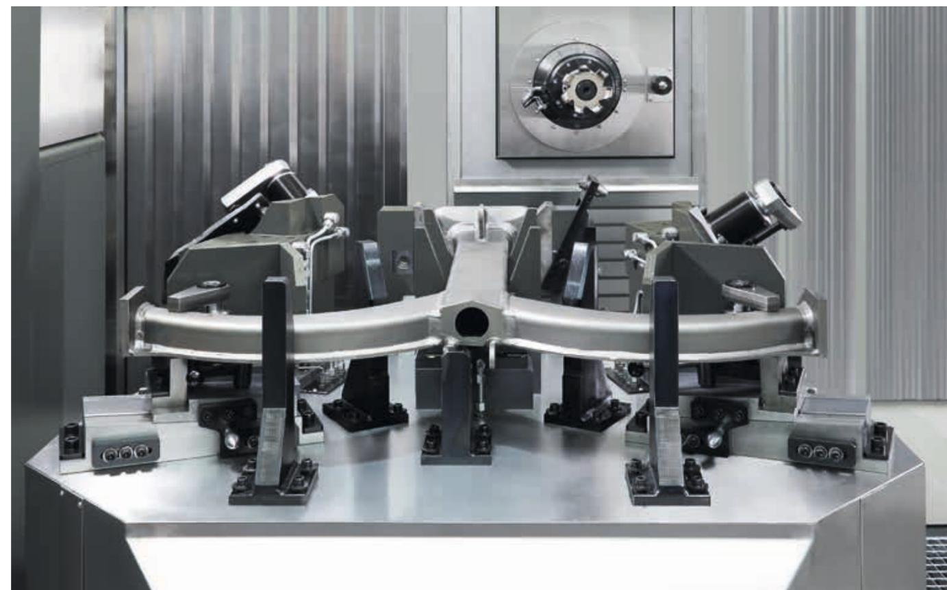
Durch den Aufbau von Spannvorrichtung und Werkstück auf einem Rundtisch lassen sich mehrere Seiten in einer Aufspannung bearbeiten
