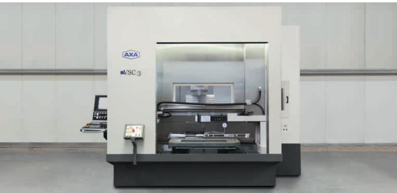
Schwenktischmaschine mit zwei Aufspannbereichen – Eine Wand in der Mitte des Rundtisches trennt die Aufspannbereiche, so dass das Werkstück bearbeitet werden kann, während hauptzeitparallel im vorderen Bereich gerüstet wird
