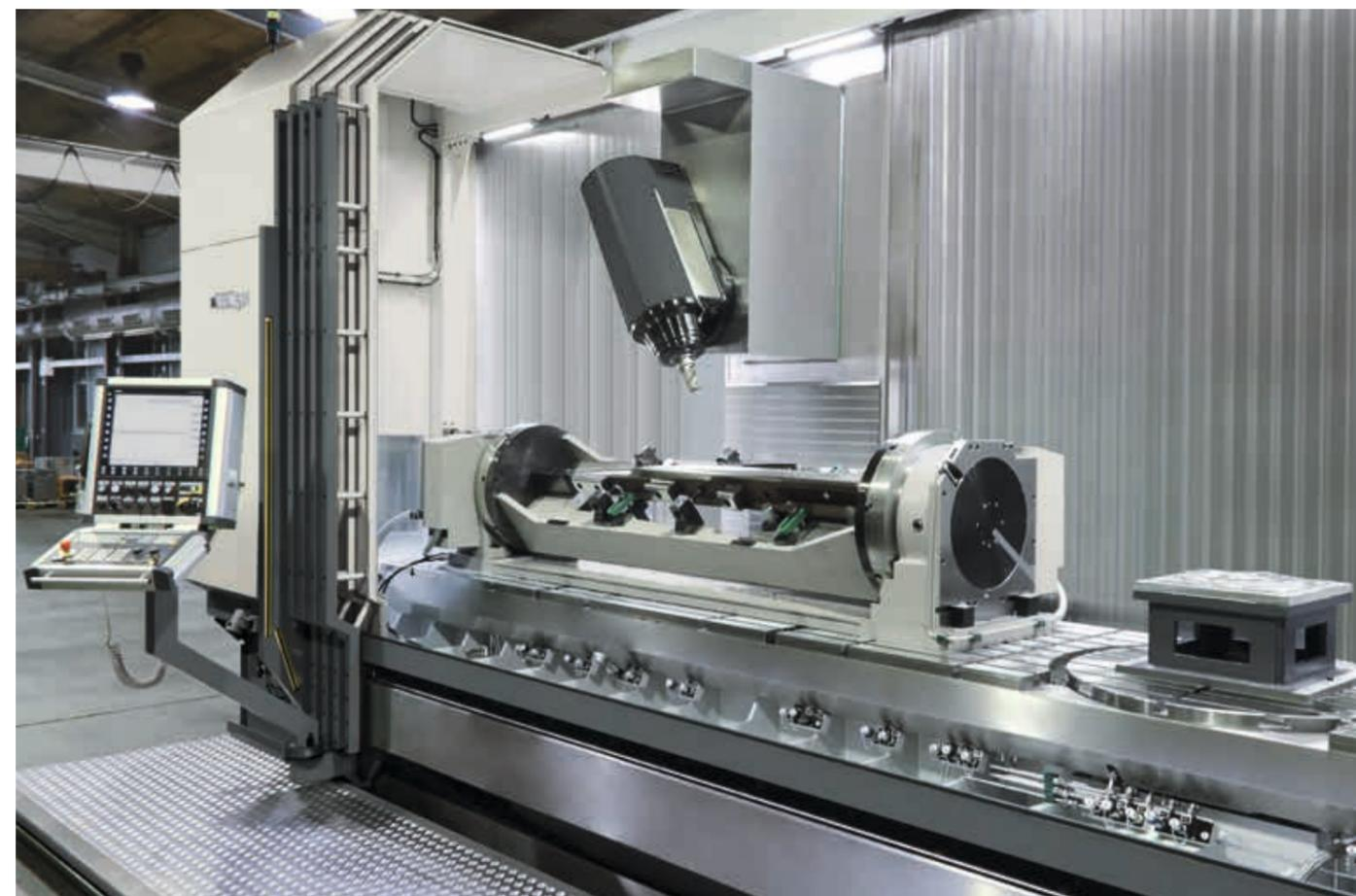
Zwei im Gantry-Verbund arbeitende NC-Rundtische sorgen für die verdrehsteife Aufhängung der langen Spannbrücke im linken Pendelarbeitsraum
