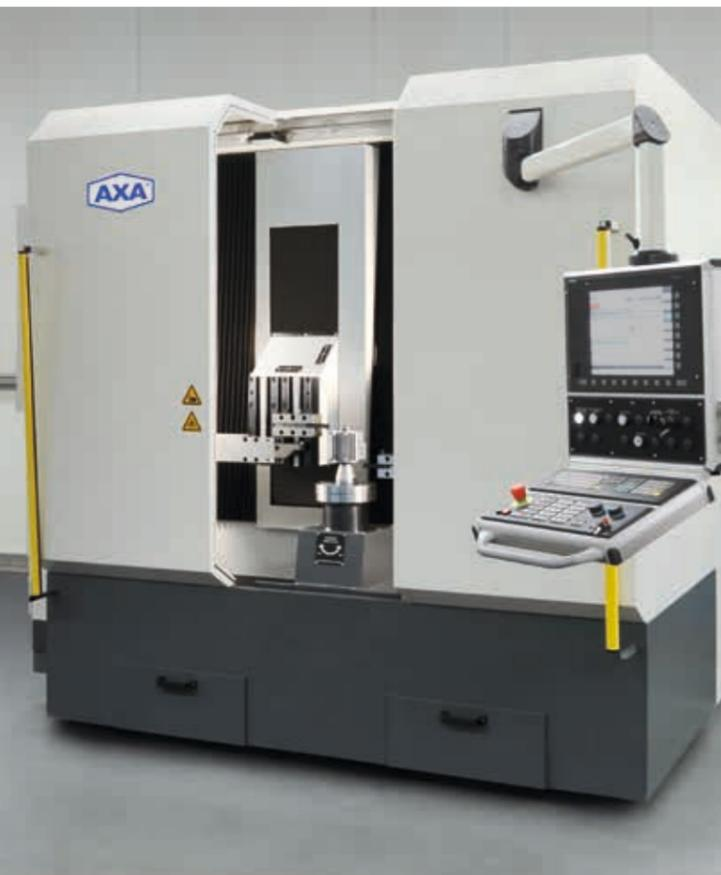
Vertikale Anordnung der Drehspindel für einen guten Spanablauf und einfache manuelle oder automatisierte Teilebeschickung
