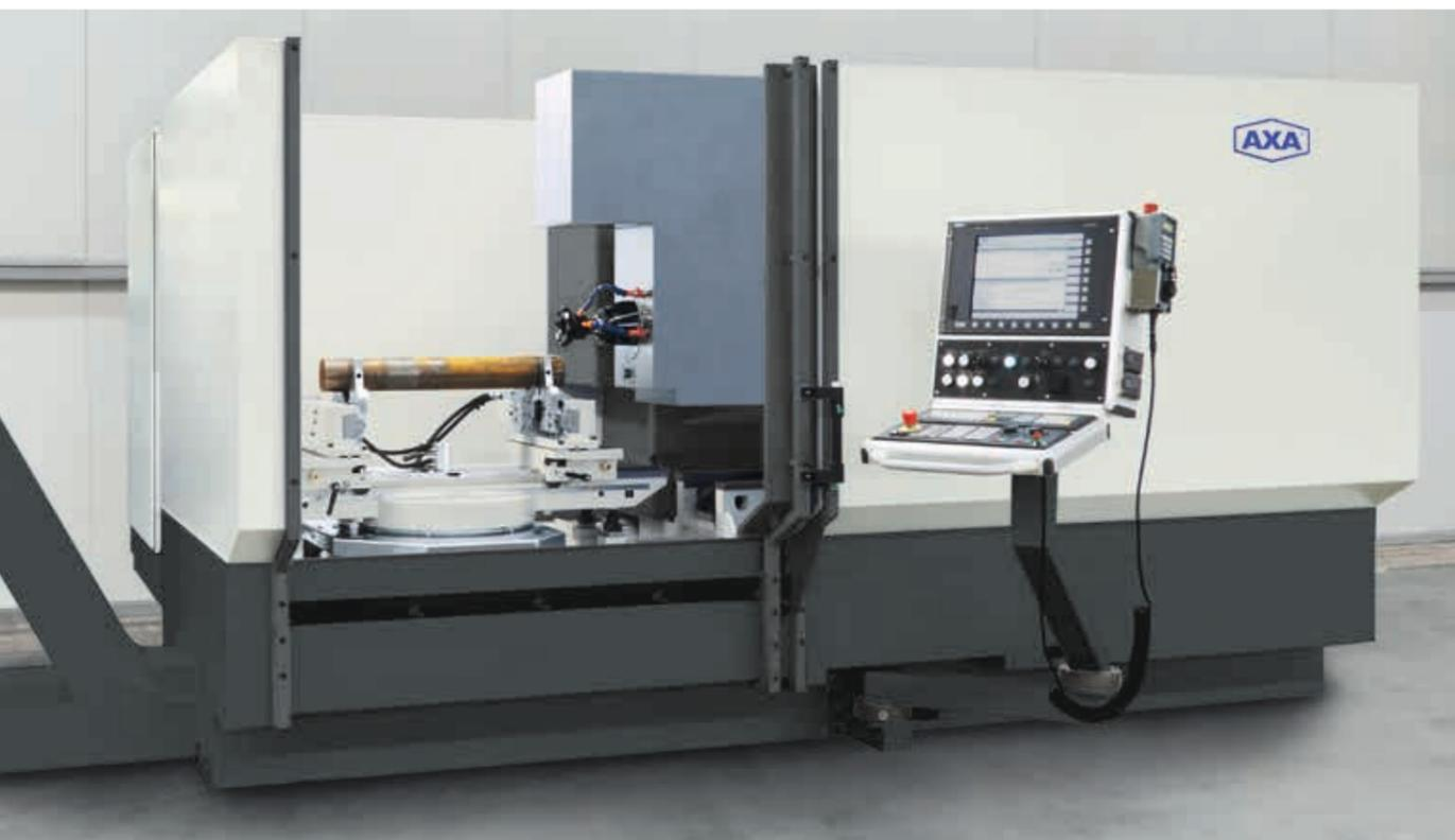
Endenbearbeitungen an kurzen Werkstücken mit horizontaler Spindel und Rundtaktisch, zum Schwenken des Werkstücks um 180°
