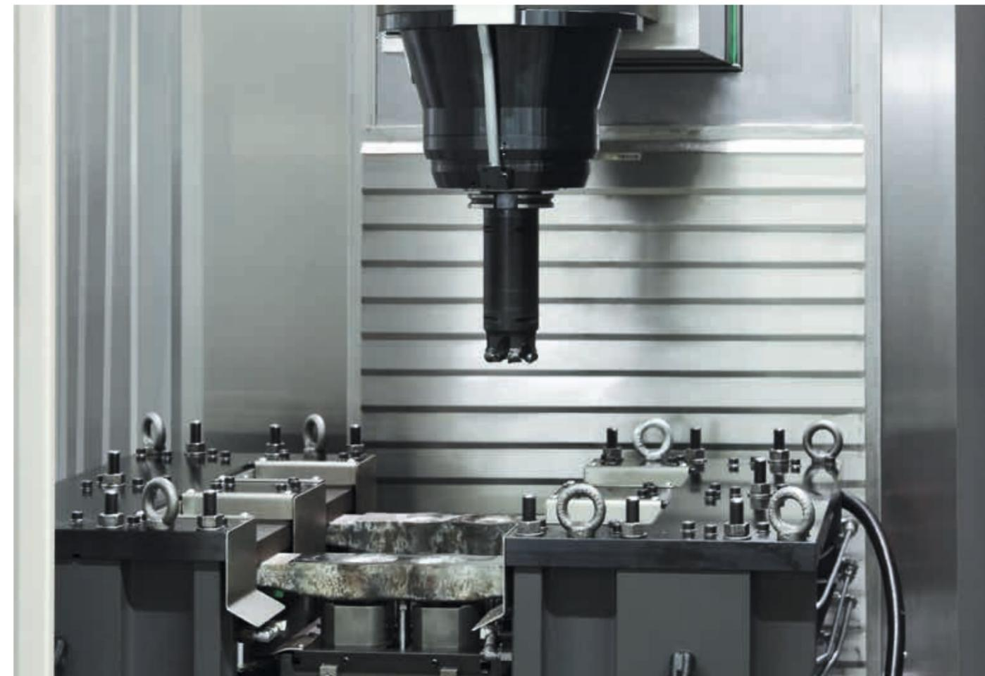
Parallele Bearbeitung zweier Werkstücke – Diese werden über Zentrierstifte ausgerichtet und von unten gegen eine hydraulisch verfahrbare Fläche gespannt
