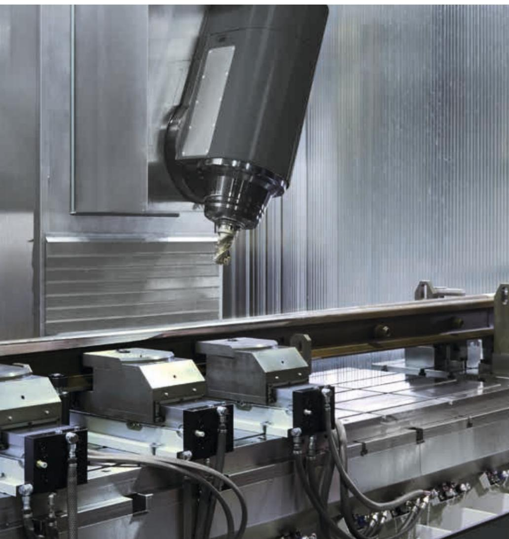
Verschiebbar angeordnete hydraulische Spannstöcke ermöglichen die sichere und variable Spannung langer Schienen
