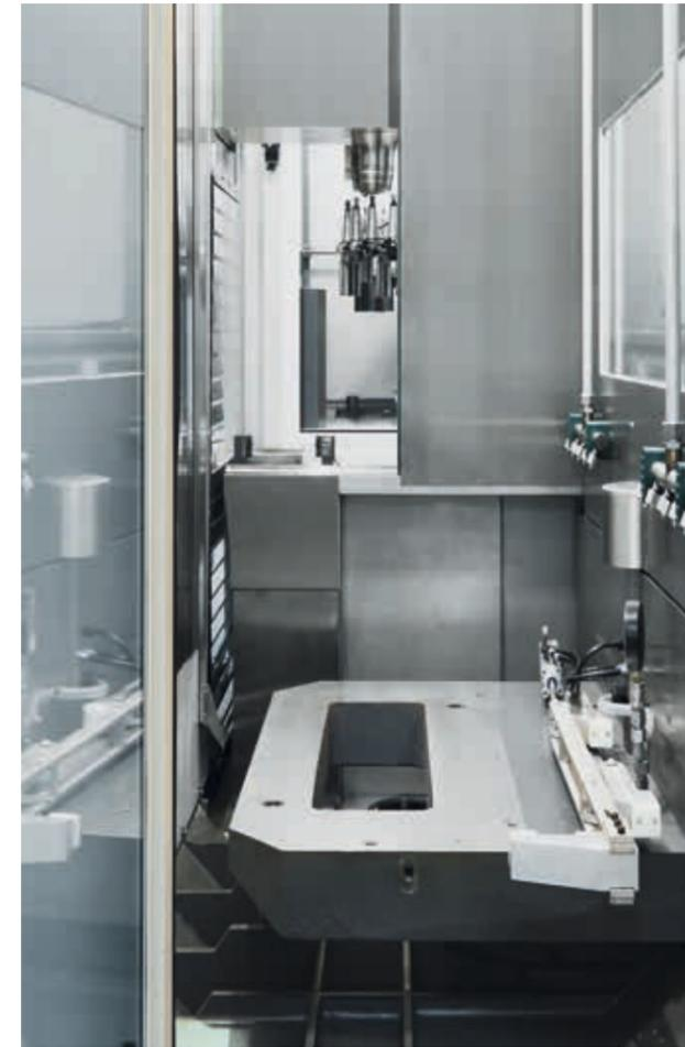
Der hintere Arbeitsraum ist für die Zerspaltung abrasiver Werkstoffe mit Leitungswasser als Kühlmedium optimiert
