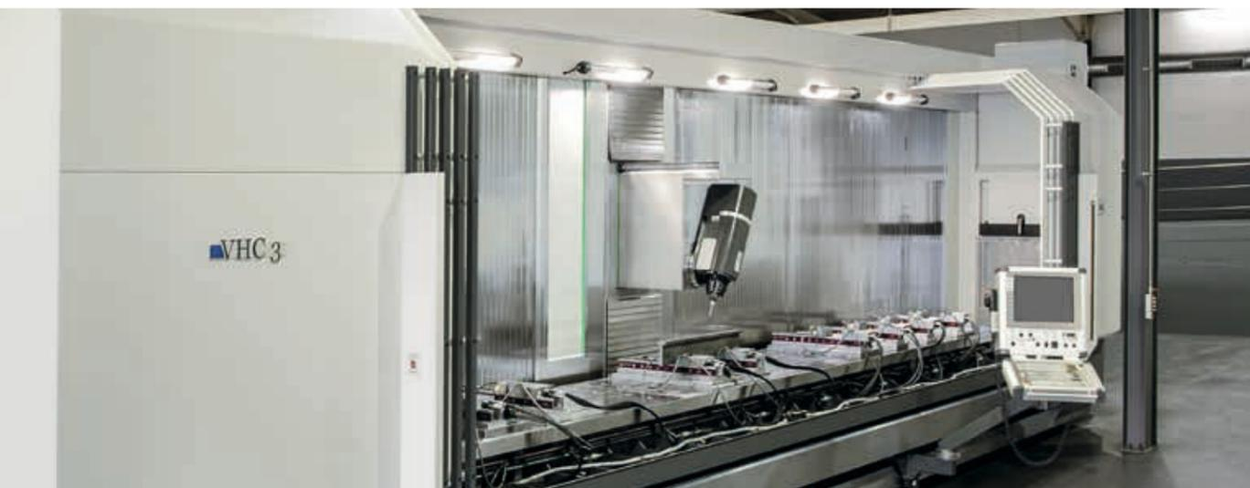
Mit dem Schwenkkopf-Bearbeitungszentrum werden lange Stahlträger spanend bearbeitet und zusätzlich Bolzen aufgeschweißt
