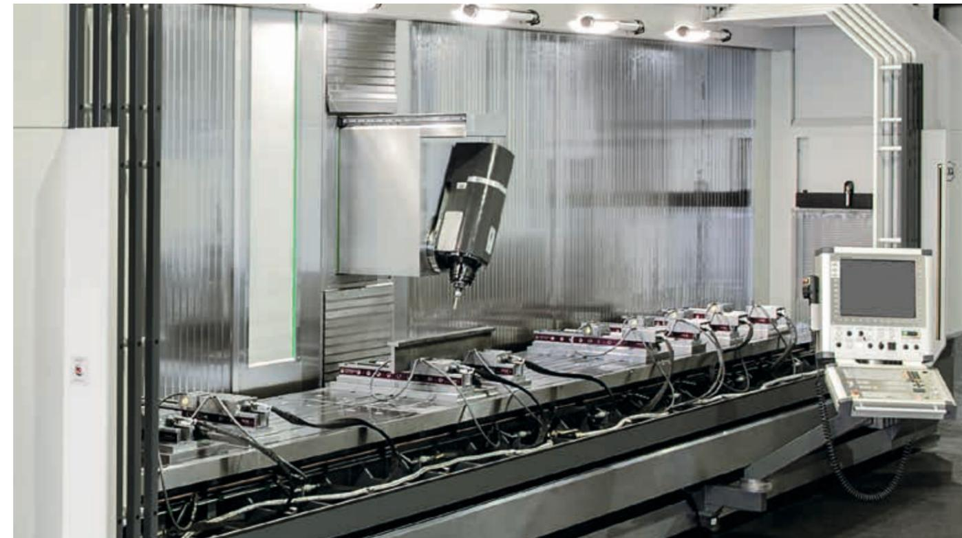
Die Spannung der Träger erfolgt in verschiebbar auf dem Maschinentisch angeordneten, hydraulischen Spannstöcken
