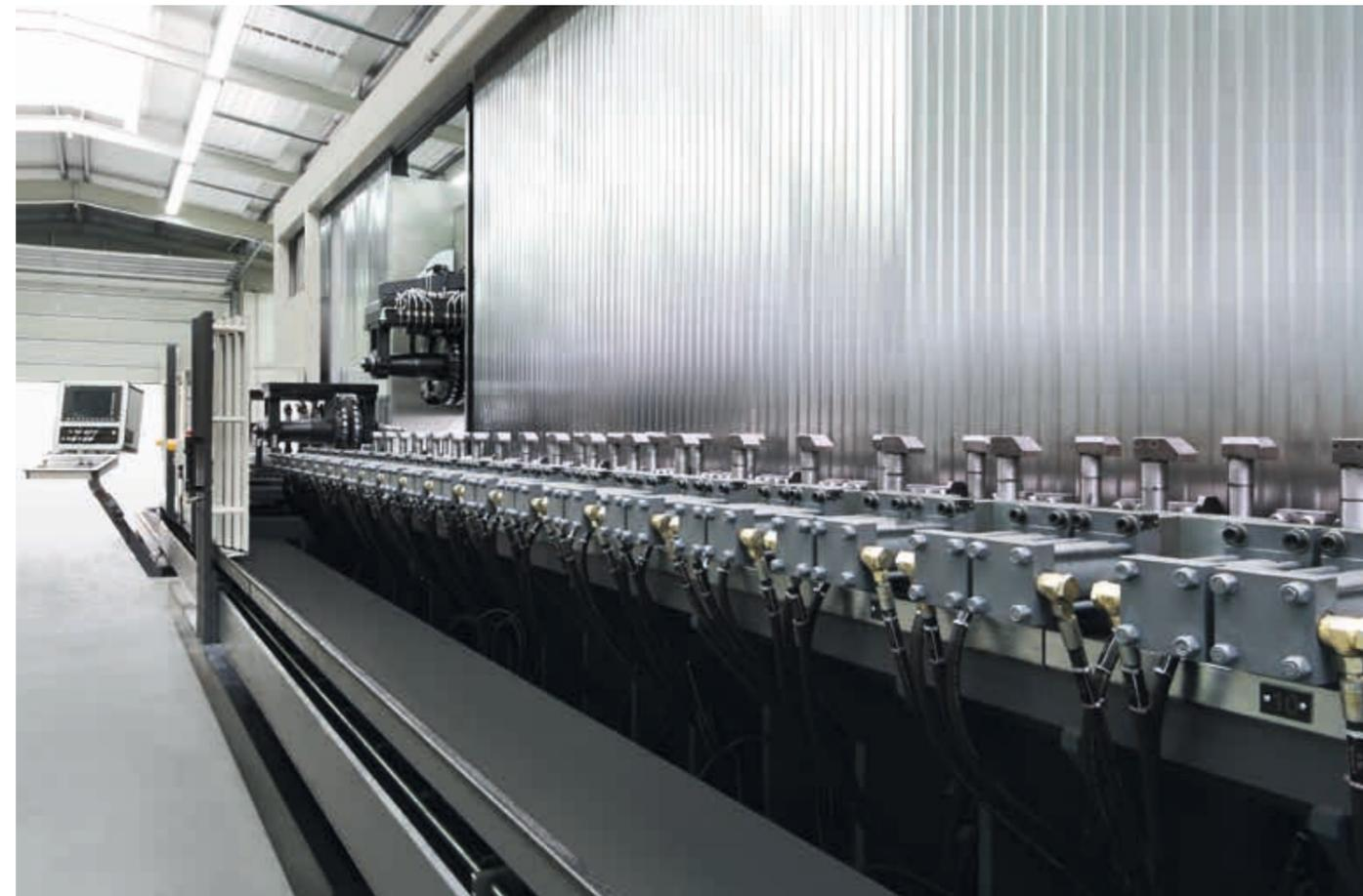
Die Spannelemente öffnen und schwenken sich jeweils zur Seite, um die zu bearbeitende Fläche für den vorbeifahrenden Fräser frei zu geben – Nachdem das Werkzeug die Stelle passiert hat, schwenken die Spanner wieder zurück und sorgen für die sichere Spannung des Werkstücks
