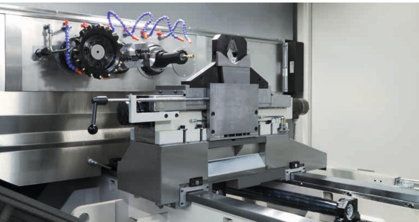
Der Z-Schlitten (Längsachse) trägt den in X-Richtung (Querachse) verfahrbaren Support mit drei fest angeordneten Spindeln
