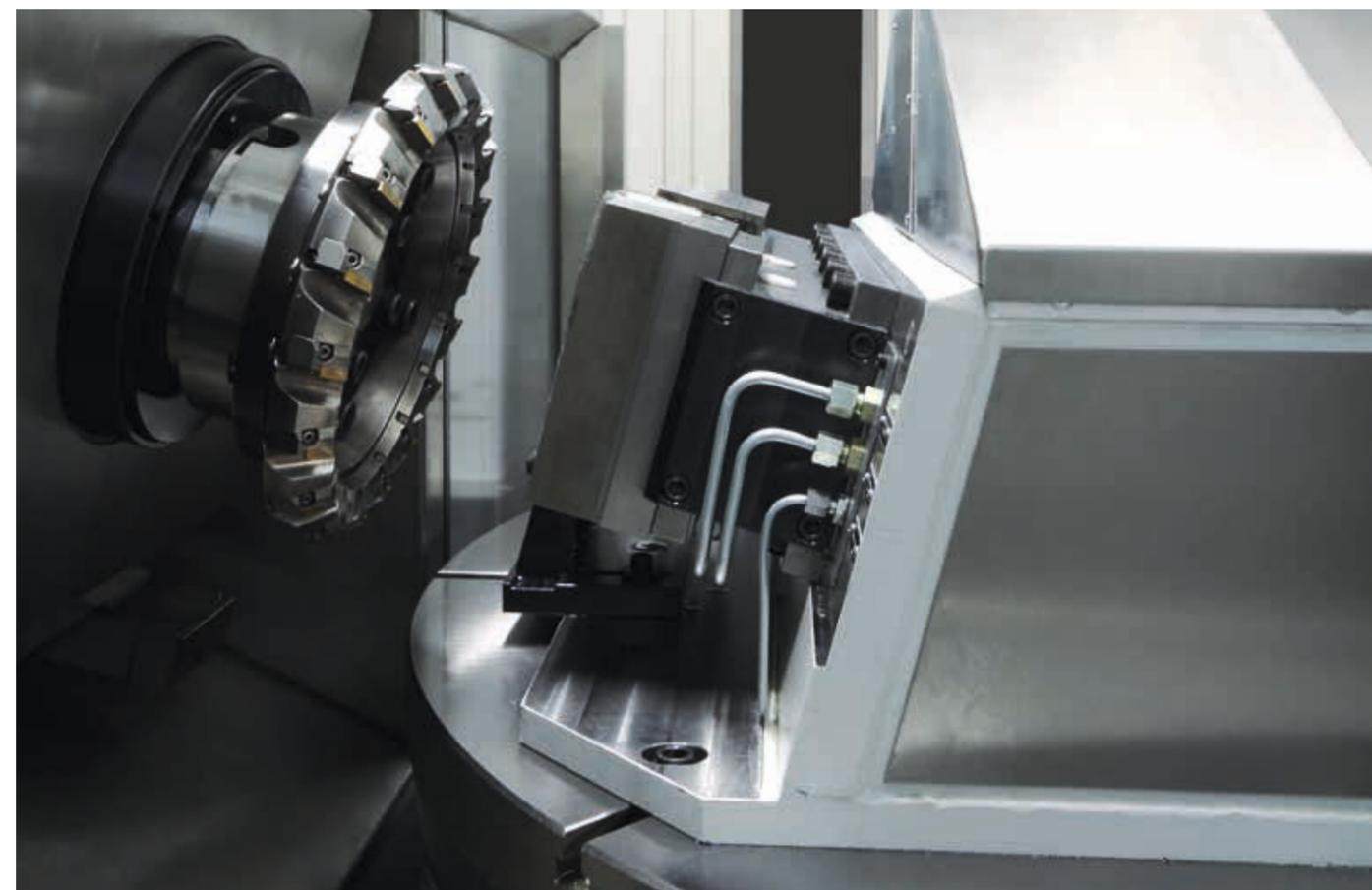
Durch die leicht geneigte Bearbeitungsposition wird ein guter Spänefluss beim Fräsen und ein ergonomisches Handling bei der Werkstückbestückung erreicht
