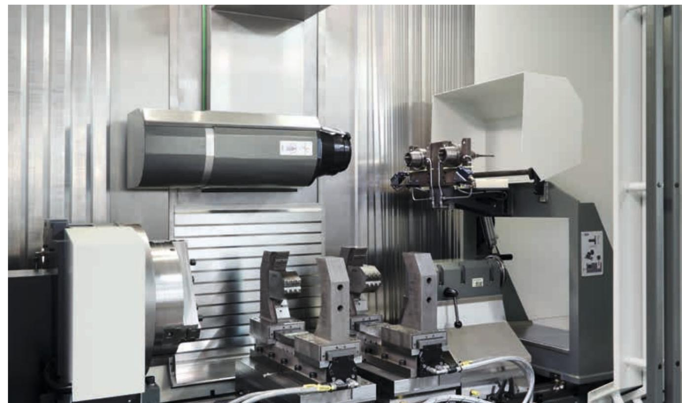
Einsatz von Sonderwerkzeugen aus einem horizontal angeordnete Pick up Magazin
