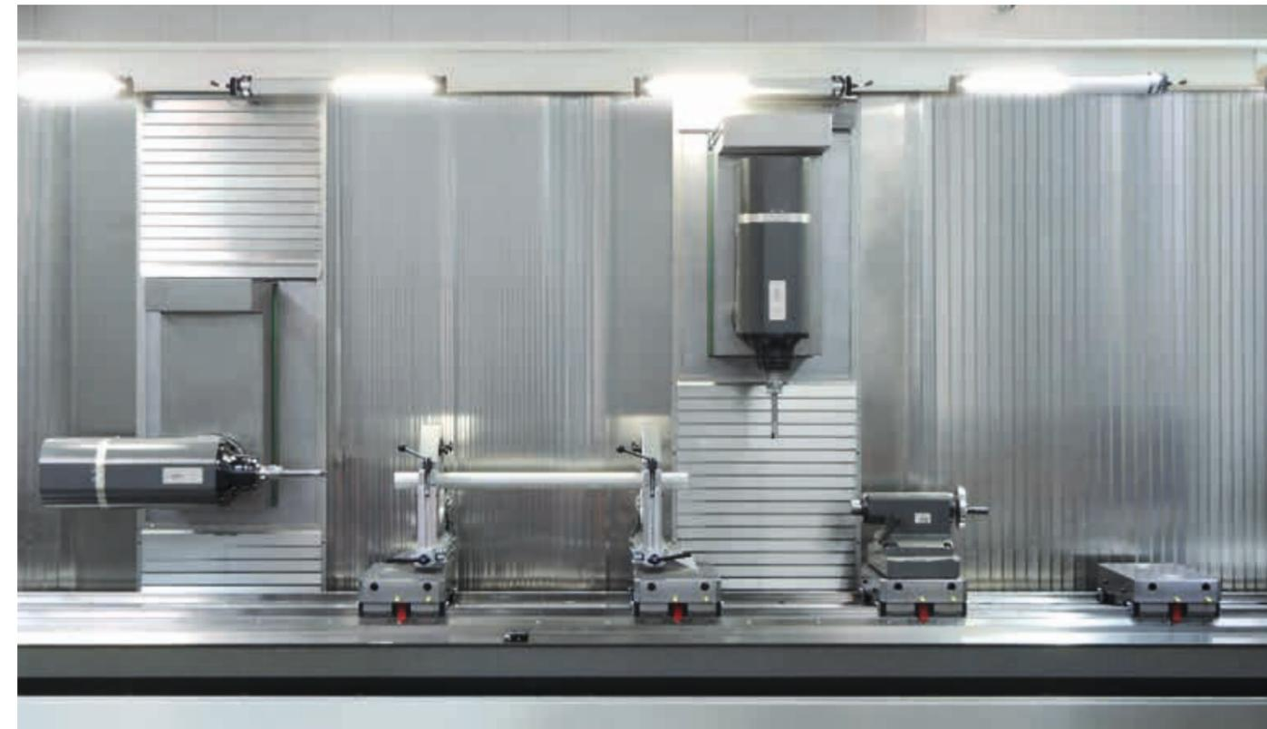
Der Tischbereich ist mit Führungsschienen versehen, auf denen Supporteinheiten mit Rundtischen, Klemmschalen und Reitstöcken flexibel bestückt und positioniert werden können
