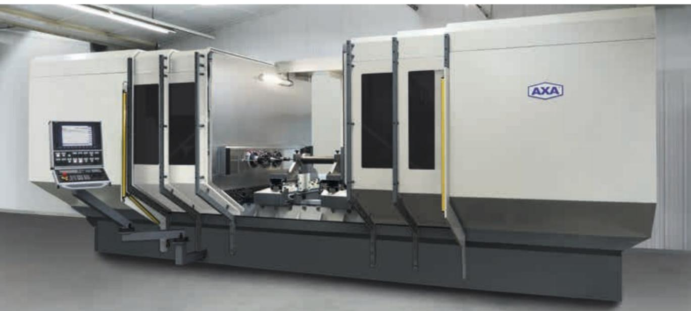
Großzügig dimensionierte, nach oben öffnende Schiebetüren ermöglichen eine gute Zugänglichkeit des Arbeitsraums und Kranbeladung
