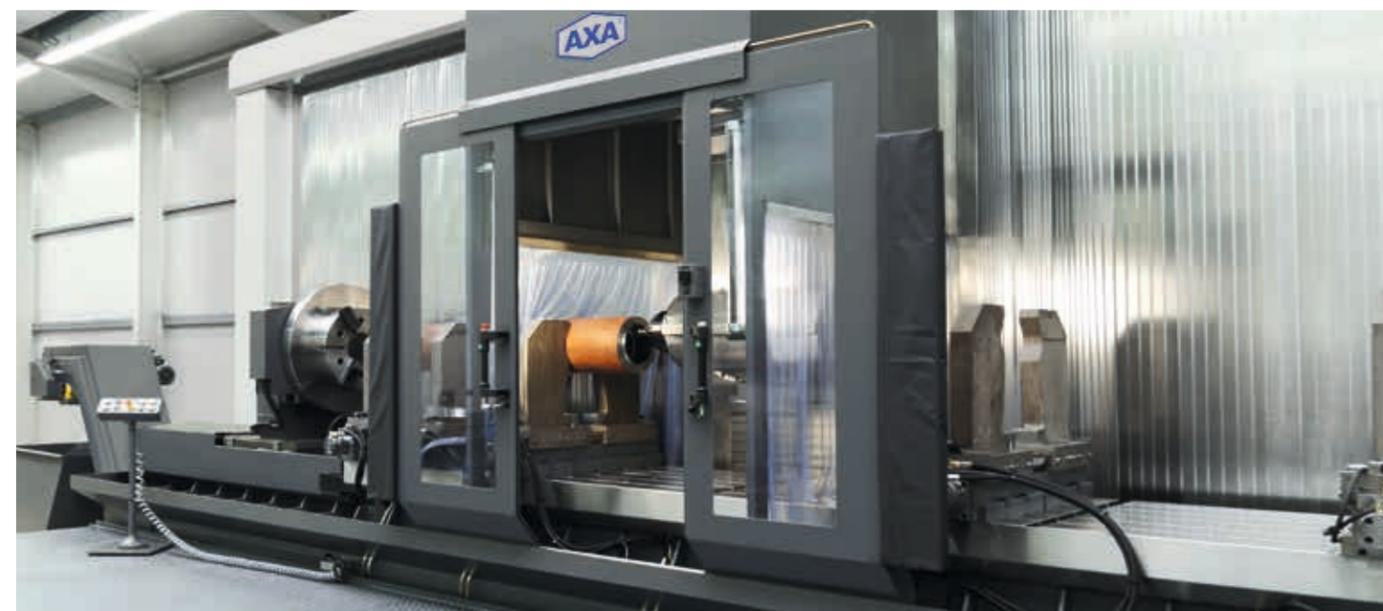
Beim Einrichten ist die Spindel durch die geöffneten Türen der mitfahrenden Haube zugänglich – Seitlich an der Haube angebrachte Sicherheitskontaktpuffer dienen als Anfahrerschutz
