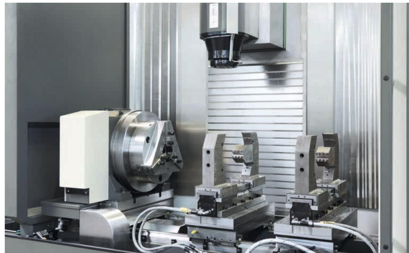
Aufnahme von Wellen und Rohren in Zentrierspannern – Mit dem links angeordneten Rundtisch und dem rechts aufgebauten Reitstock werden die Werkstücke automatisch gedreht
