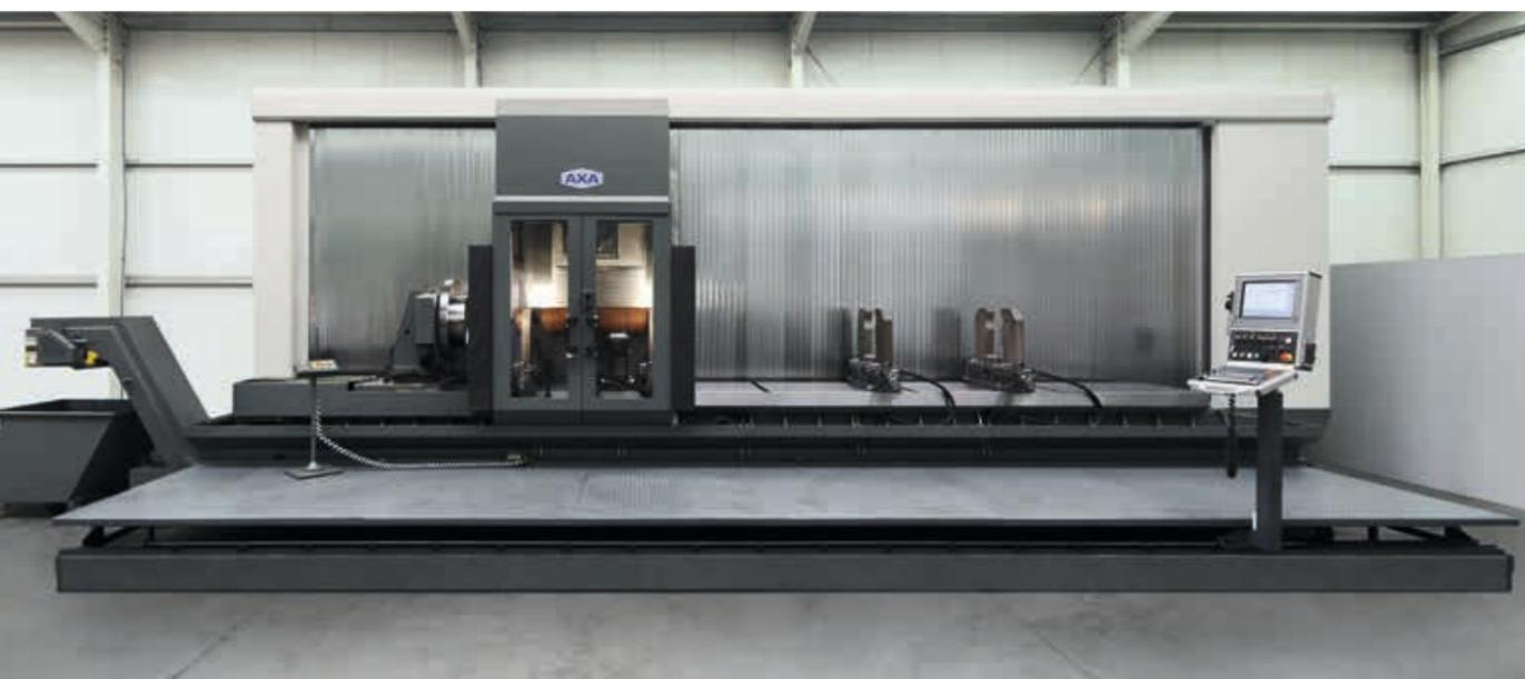
Anstatt der festen Maschinenverkleidung des schweren Schwenkkopf-Bearbeitungszentrums wird der Arbeitsraum um die Spindel durch eine, mit dem Fahrständer verfahrende Haube gekapselt
