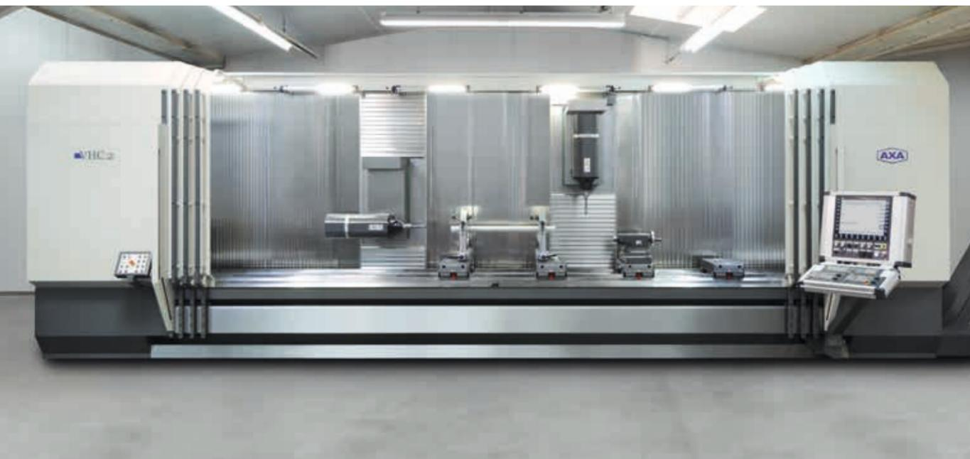
Zusätzlicher Fahrständer für das Bearbeitungszentrum – Beide Spindeln können parallel an einem Werkstück verwendet werden oder unabhängig an einem separaten Werkstück zum Einsatz kommen
