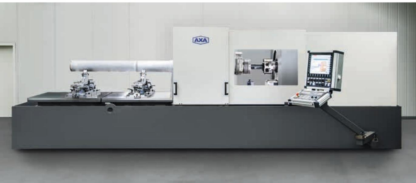
Einseitige Nachbearbeitung von Dichtflächen an langen Rohren
