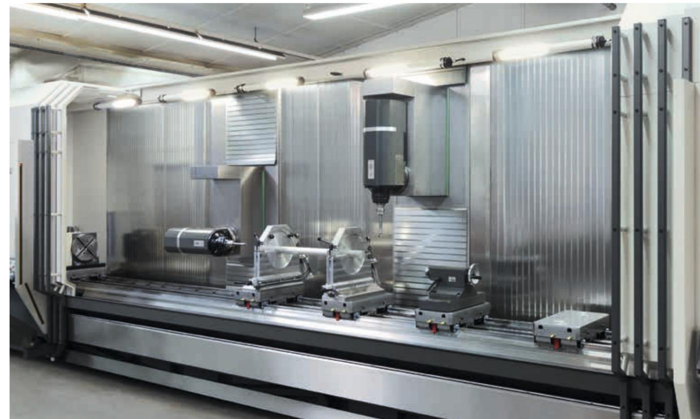
Mittels Rundtisch und Reitstock können die Werkstücke zusätzlich zu den Schwenkspindeln in Position gedreht werden
