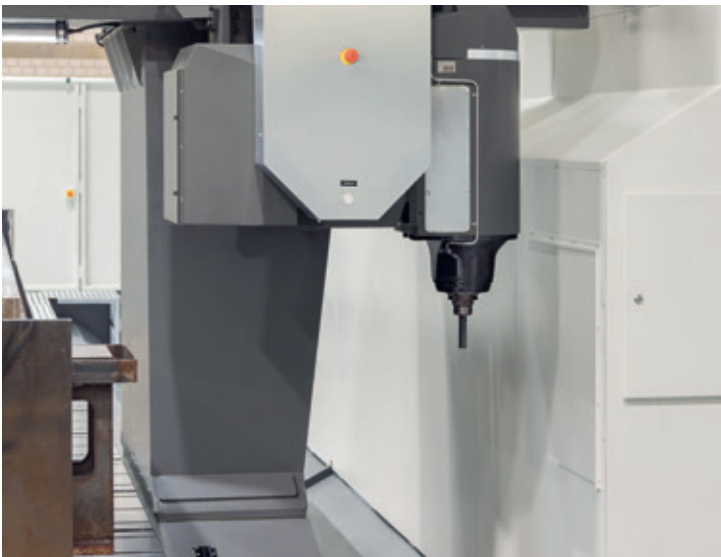
Spindel fährt in Position für den Werkzeugwechsel
