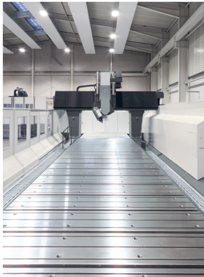
Maschinentische in Serie mit integrierten T-Nuten zur Werkstückaufspannung
