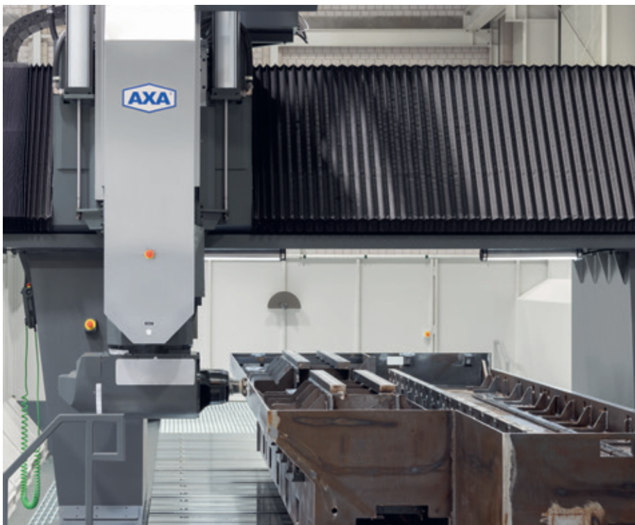
Durch den erweiterten Y-Verfahrweg wird nahezu die gesamte Tischbreite genutzt - ein Vorteil für die Bearbeitung von sehr breiten Werkstücken
