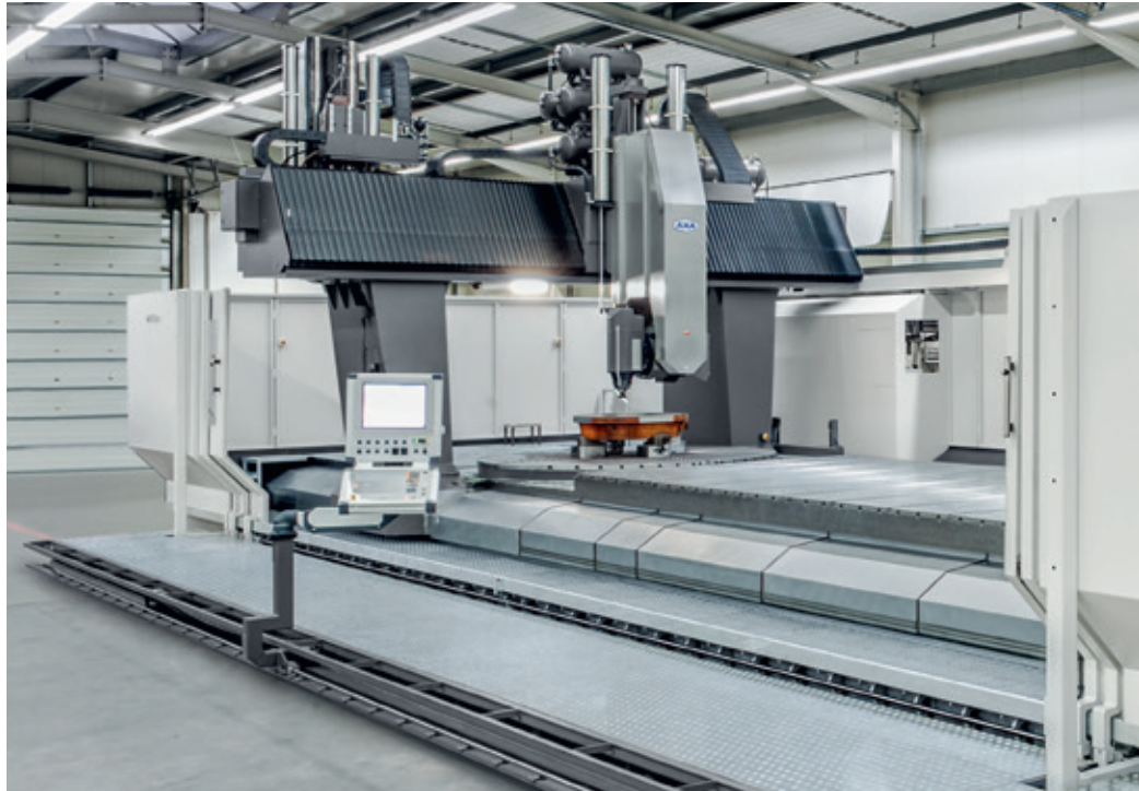
Fräsbearbeitung - serienmäßiger 2-Achs-Schwenkkopf für Fräs- und Bohrbearbeitungen
