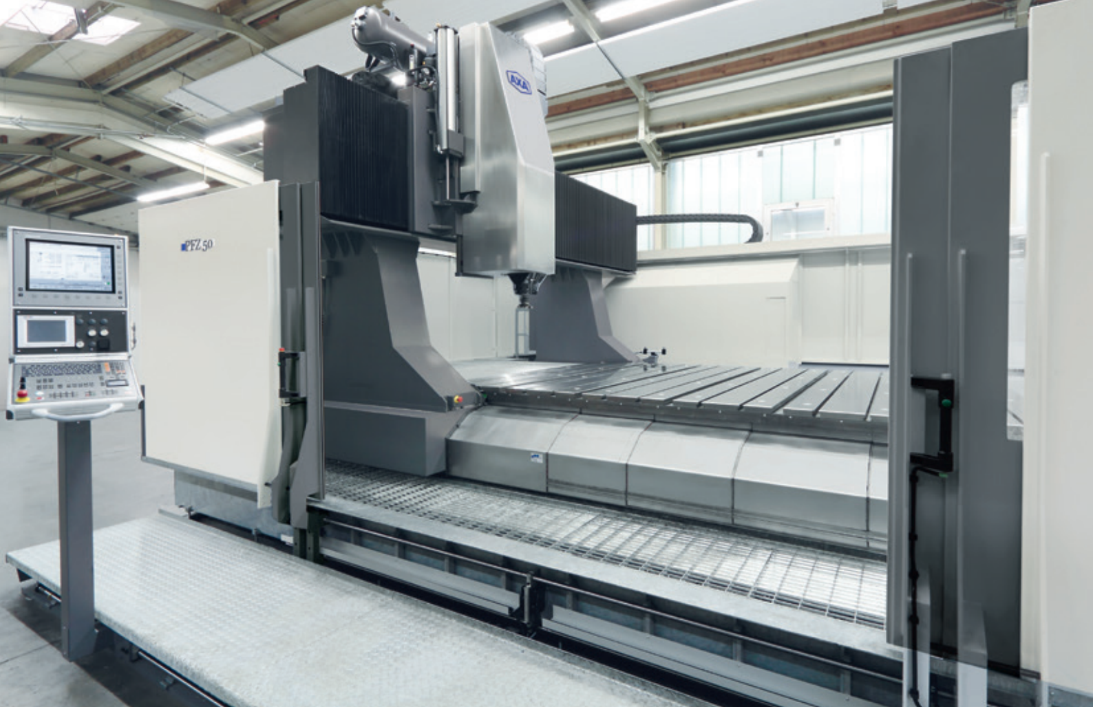
Das Groß-Portalbearbeitungszentrum PFZ: optimale Bearbeitung von großflächigen Werkstücken
