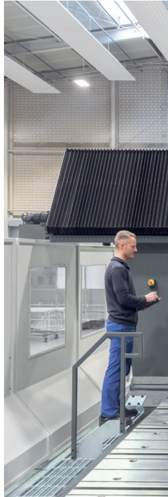
In horizontaler Spindelstellung (A-Achse um 90° geschwenkt) lassen sich die Längs- und Stirnseiten der Werkstücke bearbeiten
