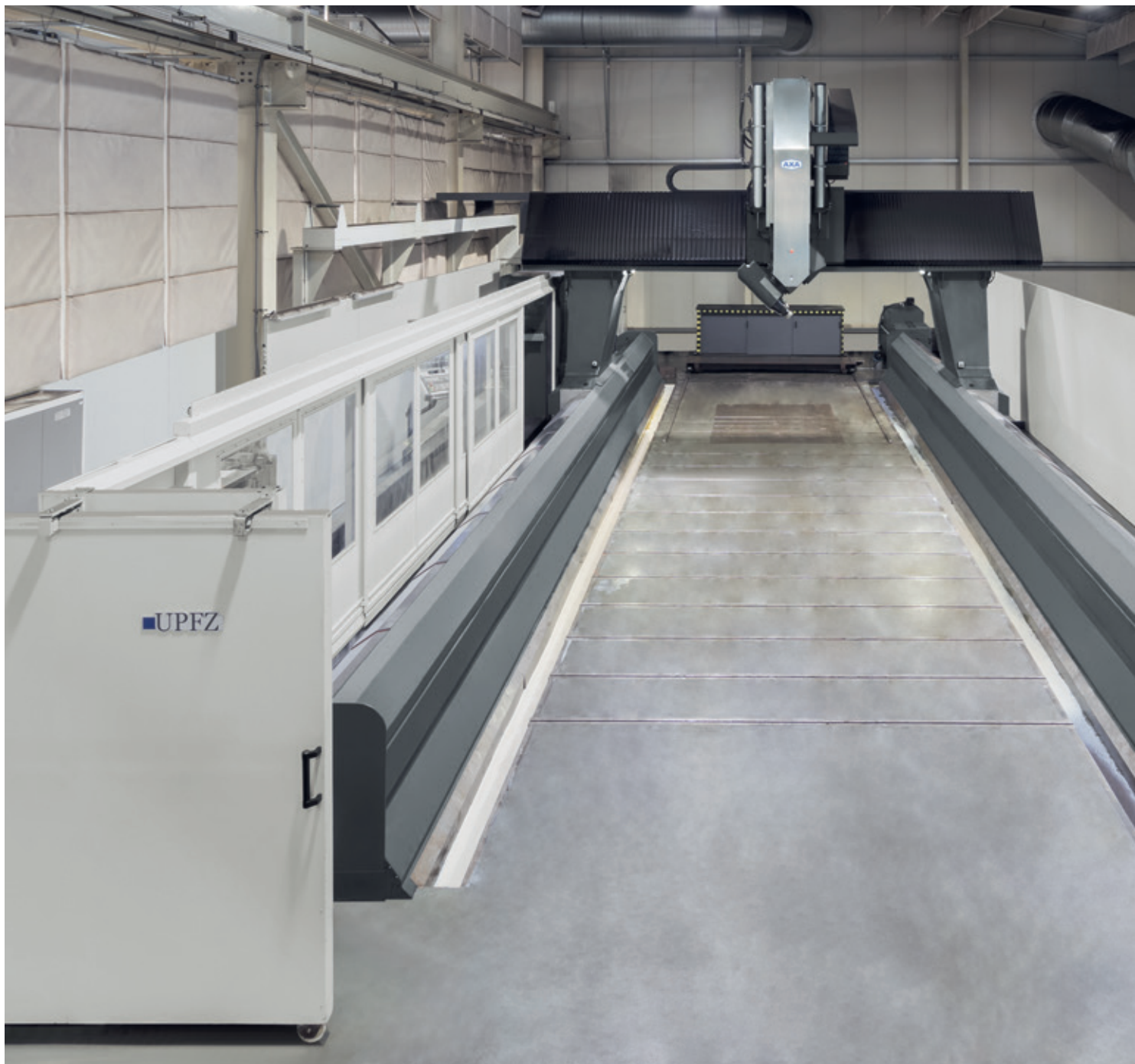
Portalbearbeitungszentrum UPFZ in Sonderbauform - ohne Maschinentisch, mit Rundumverkleidung und stirnseitigen Türen
