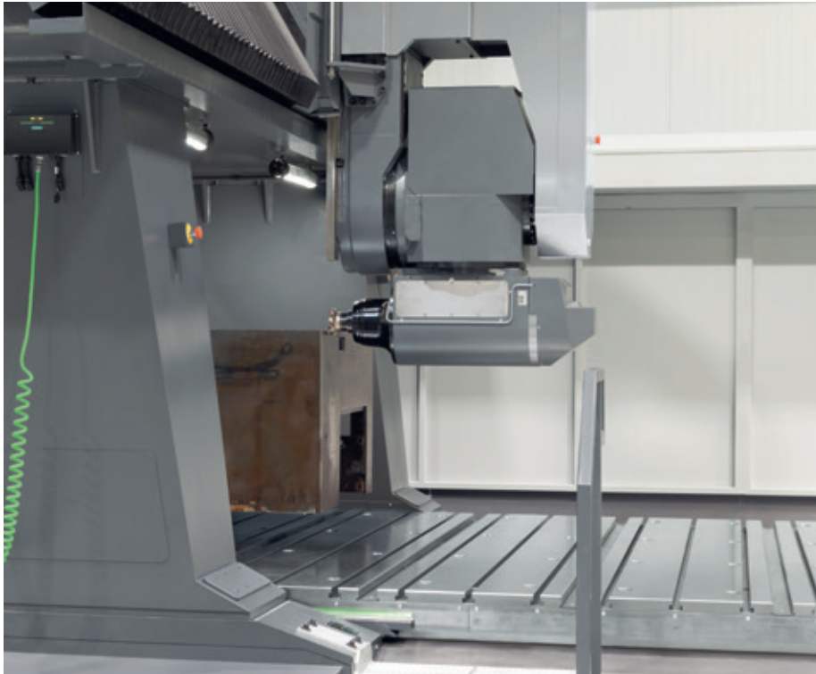
In horizontaler Spindelstellung (A-Achse um 90° geschwenkt) lassen sich die Längs- und Stirnseiten der Werkstücke bearbeiten
