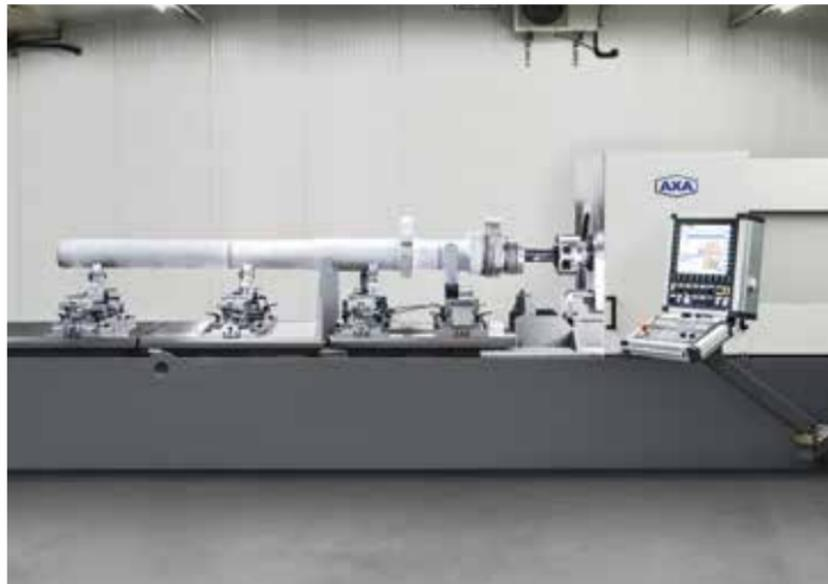
Einseitige Nachbearbeitung von Dichtflächen an langen Rohren
