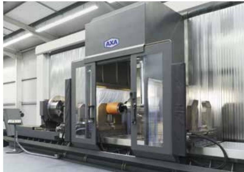
Arbeitsraumkapselung durch eine verfahrende Haube anstatt einer festen Maschinenverkleidung
