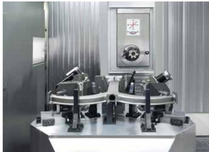
Komplettbearbeitung mehrerer Einzelteile einer Baugruppe durch den Aufbau von Spannvorrichtung und Werkstück auf einem Rundtisch
