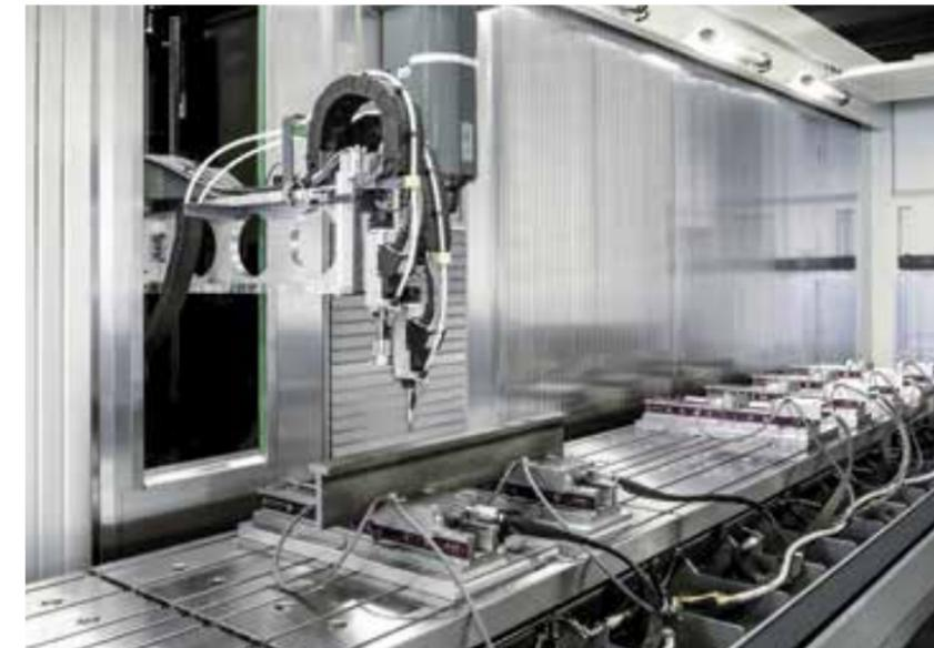
Fräsbearbeitung und Punktschweißen von Gewindebolzen in einer Aufspannung
