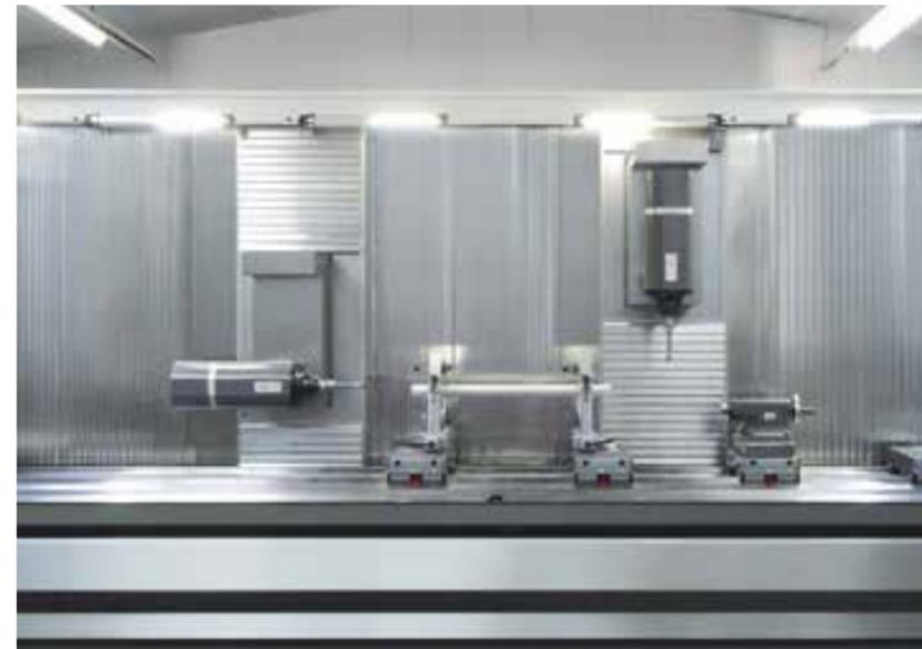
Parallele Zerspänung eines oder mehrerer Werkstücke mit der Doppel-Fahrständermaschine
