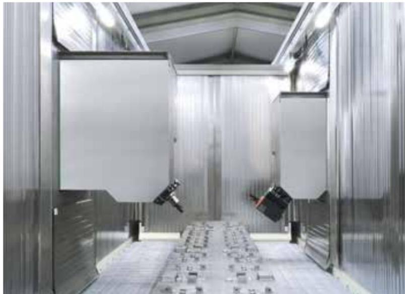
Zwei um die X-Achse schwenkbare Arbeitsspindeln zur flexiblen Fertigung beliebiger Konturen
